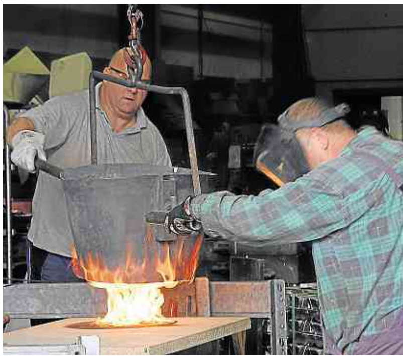
Ein heißes Geschäft, der Guss beginnt: Auf 800 Grad wird die Aluminiumlegierung zunächst für die Läufer-Skulptur erhitzt. Handschuhe und Visier schützen die Gießer beim Hantieren mit dem Bottich. Foto: Ernst-Peter Strauch
